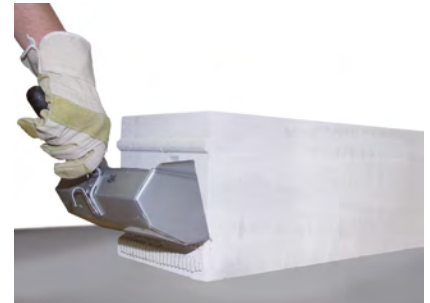
... Plansteinkelle B = 240 mm über die Profilierung ...
